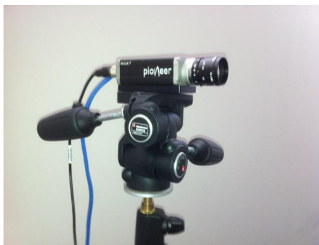
Figura 6. Detalle de una de las cámaras de visión de alta resolución de BASLER.
